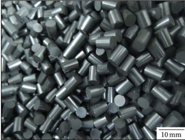
Sinterlenmiş gözenekli UO 2 seramik yakıt peleti
